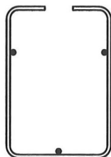
Bild 3: Bügelkorb für \Delta \sigma_{Rsk} = 85 \text{ N/mm}^2 (bei N=1 \cdot 10^6 Lastw.)
