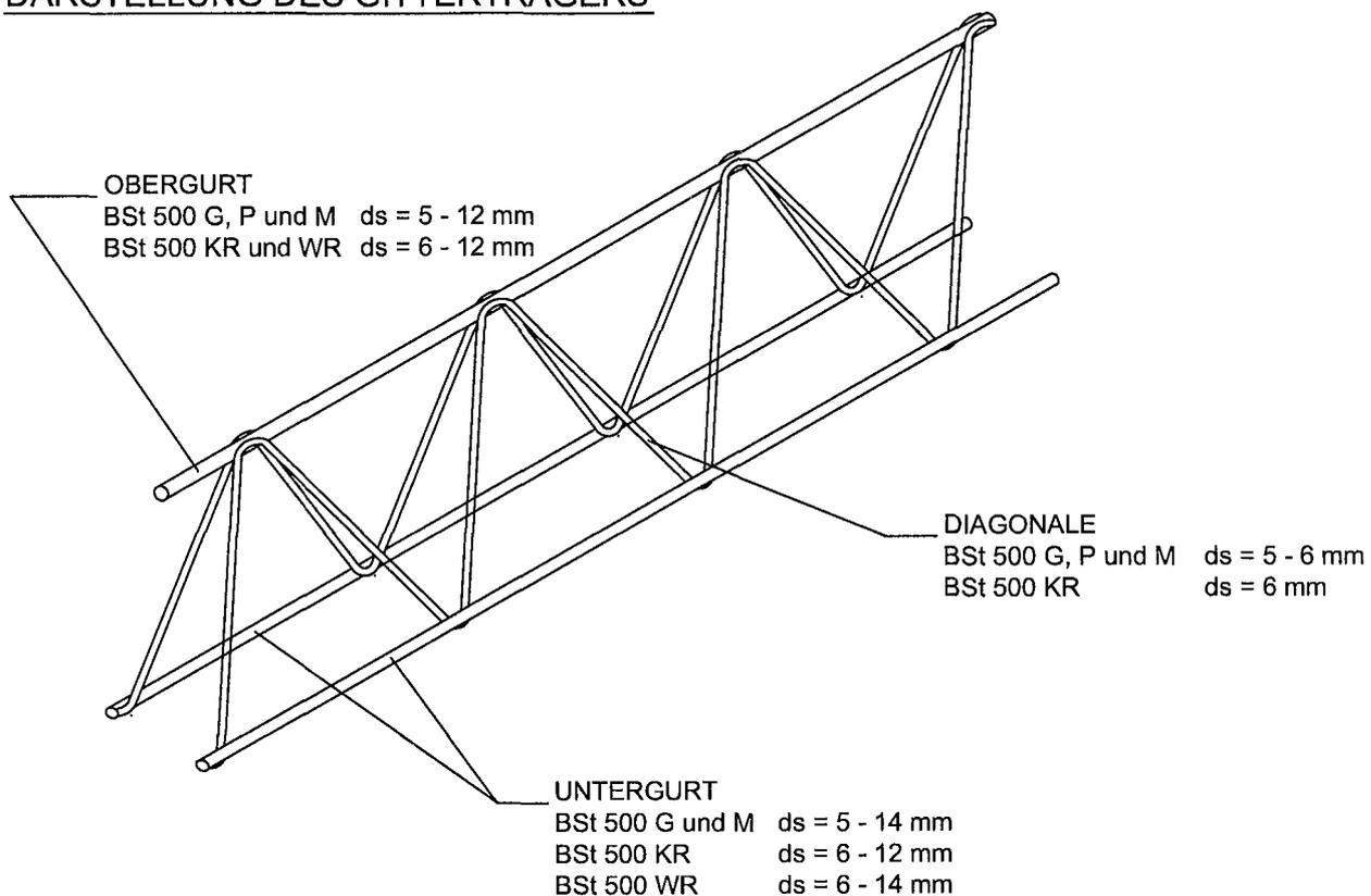
(Durchmesser in Abhängigkeit der Betonstahlsorte, siehe "Besondere Bestimmungen", Tabelle 1)
