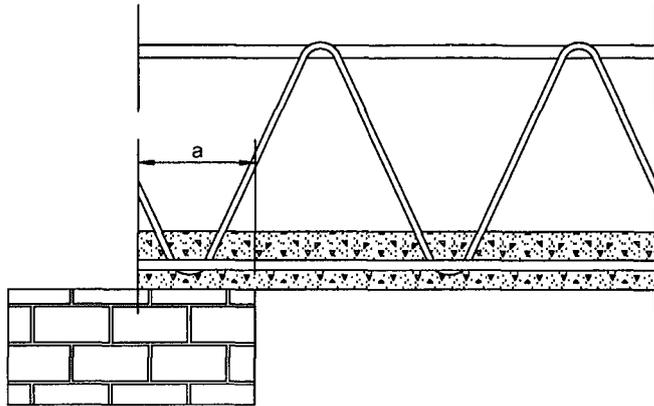
Eine Montageunterstützung am Auflager ist nicht erforderlich, wenn je Gitterträger ein Untergurtnotenpunkt auf dem Auflager liegt und bei Fertigplatten die Auflagertiefe mindestens 3,5 cm bzw. bei Betonfußleisten die Auflagertiefe  $a$  mindestens 10 cm beträgt.
