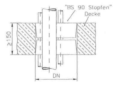
Kabelabschottung in Decken mit einer Dicke ab 150 mit einem Futterrohr
