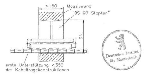
Kabelabschottungen in Wänden mit Dicken von 100 mm - 150 mm in Futterrohren (Einbau wahlweise einseitig oder beidseitig überkragend)
