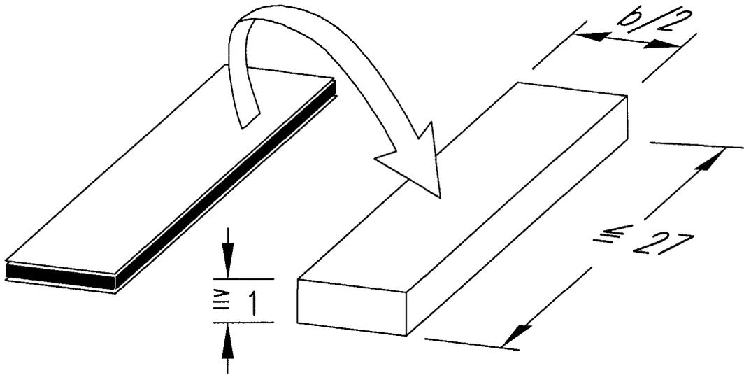
Der Vakuumsstein wird in die Restspalte eingefügt und verschließt diese nach Öffnen der Folie.
