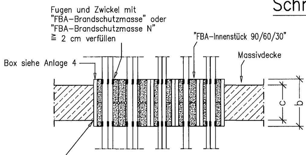
Fuge zwischen Decke und Box von der Deckenunterseite her mit mineralischem Mörtel, Gips, "FBA-Brandschutzmasse" oder "FBA-Brandschutzmasse N" in einer Tiefe  $\cong 2$  cm verschließen
