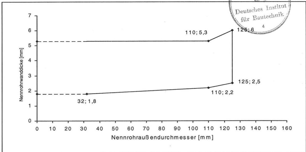
**Dicke der Brandschutzeinlage:** D = 4 mm für  $\varnothing \leq 110$  mm und D = 8 mm für  $\varnothing > 110$  mm
