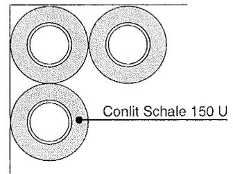
Alle Rohre dürfen mit „Null-Abstand“ (siehe Abschnitt 3.2.2.1) verlegt werden. „Null-Abstand“ auch mit nichtbrennbaren Rohren gemäß ABP P-3725/4130 MPA-BS zulässig
