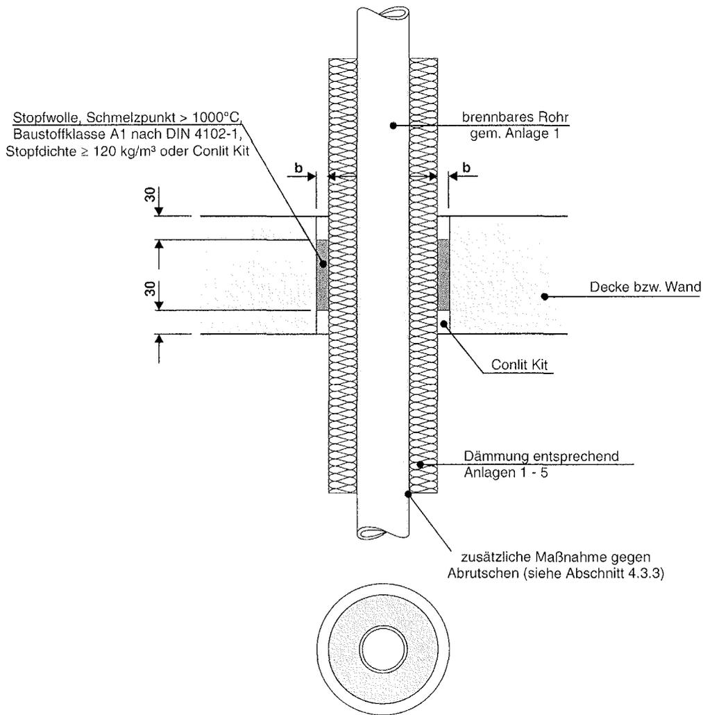
Ringspaltbreite  $b$ :  $5 \text{ mm} \leq b \leq 15 \text{ mm}$
