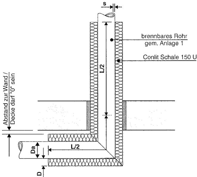
**Prinzipskizze für Abstandsregelung bei Wand und Decke**
