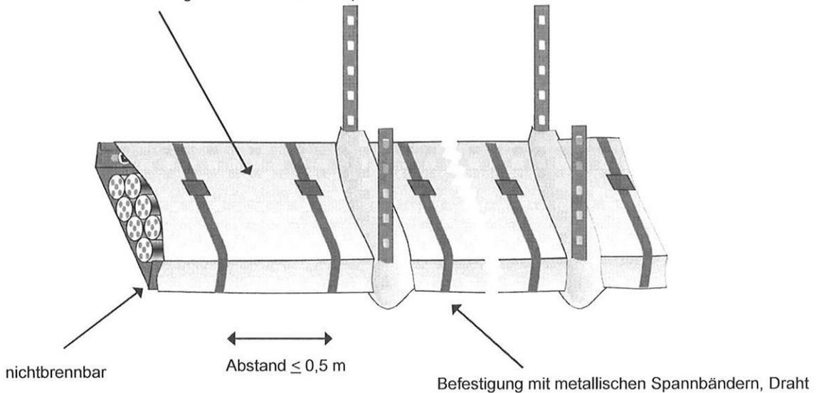
**Einbausituation mit äußerer Brandschutzumhüllung und Abstand zwischen Brandschutzumhüllung und der Kabeloberfläche  $> 30$  mm**
