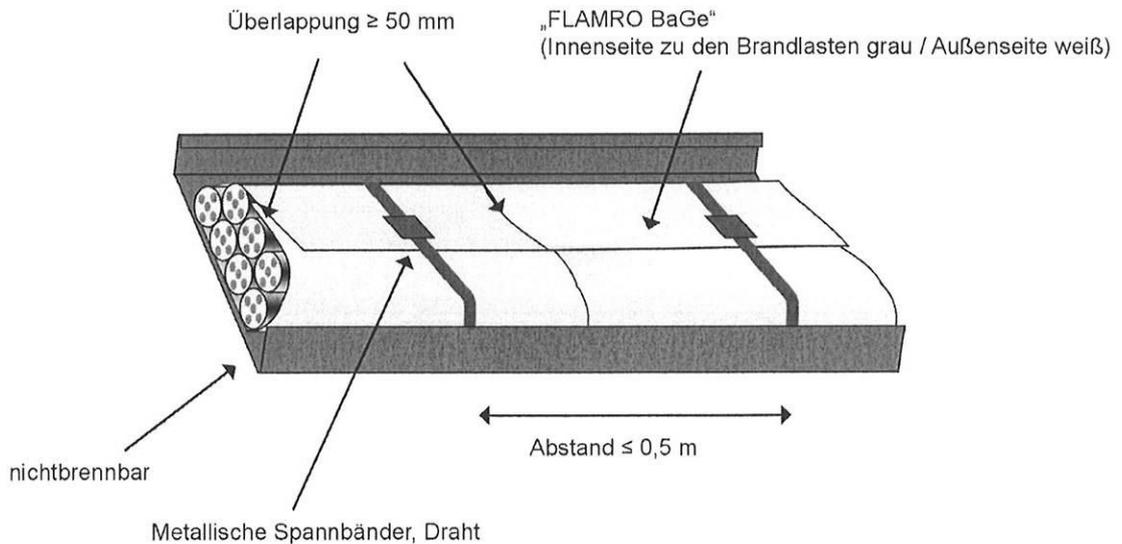
Einbausituation äußere Brandschutzumhüllung bei Steigetrassen
