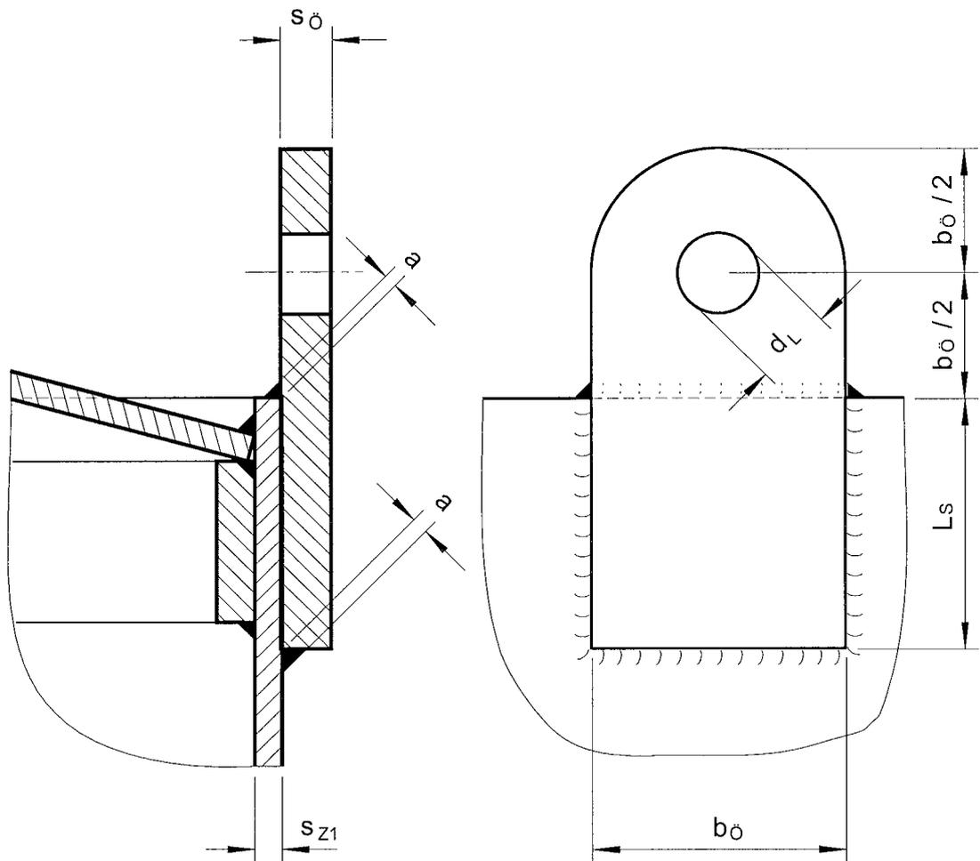
$$a \geq 0,7 \cdot s_{z1} \quad (\text{umlaufend})$$
