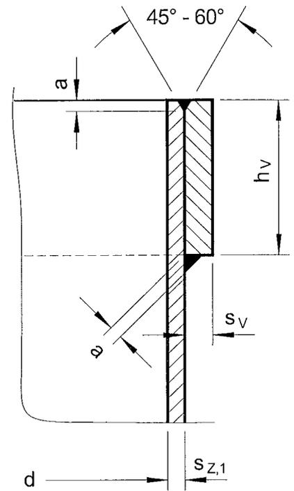
Die Randverstärkung darf auch an der Zylinderinnenfläche angebracht werden.
