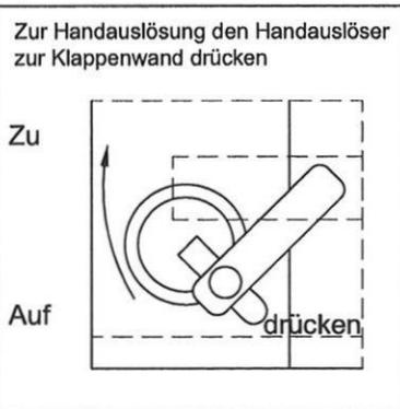
Schilder werden dauerhaft an der Handhebelseite jeder Absperrvorrichtung angebracht
