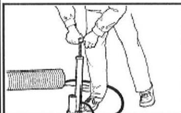
5) Hitzebeständige Druckblase mittels Luftpumpe auf einen Druck von 1,5 bar expandieren
