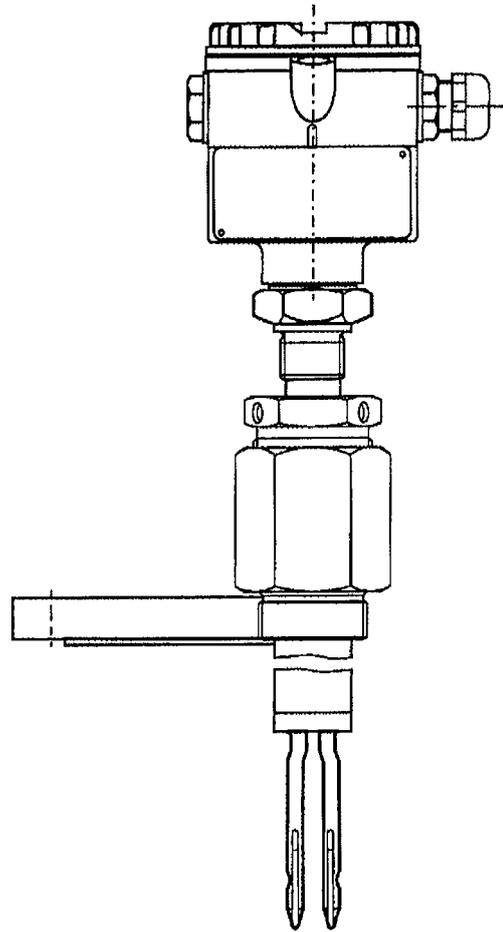
Schema der Überfüllsicherung
