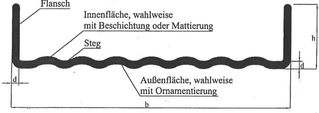
Profilquerschnitt d: Dicke
