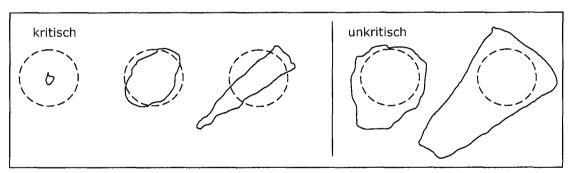
GLAS TRÖSCH GmbH Reuthebogen 7-9 D-86720 Nördlingen Prüfung der Bruchstruktur von Testplatten in Bauteilgröße ANLAGE 2
