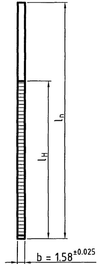
Ausgangsmaterial: Stahldraht  $\phi 1.52 \pm 0.01$  aus Werkstoff 1.4301 (X 5 Cr Ni 18 9 = V2a) nach DIN 17440
