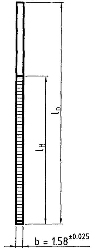
Ausgangsmaterial: Stahldraht  $\phi 1.52 \pm 0.01$  aus Werkstoff 1.0413/1.0414 (D 15-2/D 20-2) nach DIN EN 10016-2 mit einer Festigkeit von 900-1100 N/mm<sup>2</sup>
