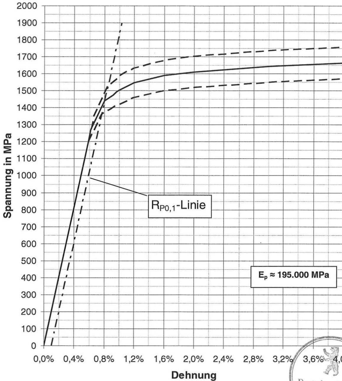
Die gestrichelten Linien zeigen die Differenzen an, die in der Spannungs-Dehnungs-Linie auftreten können
