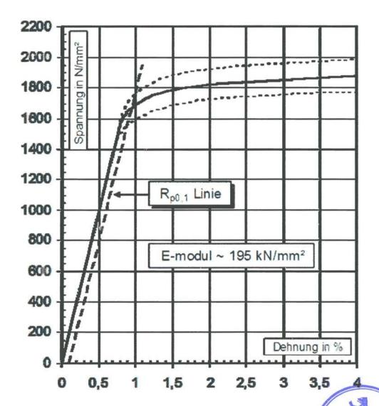
Die gestrichelten Linien markieren den Bereich, innerhalt dessen die tatsächlichen Spannungs – Dehnungslinien auftreten können.
