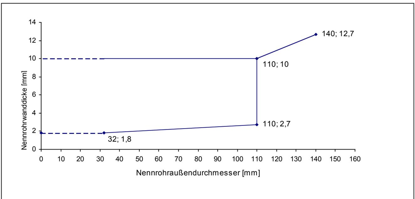
Dicke der Brandschutzeinlage: D = 4 mm für  $\varnothing \leq 110$  mm und D = 8 mm für  $\varnothing > 110$  mm
