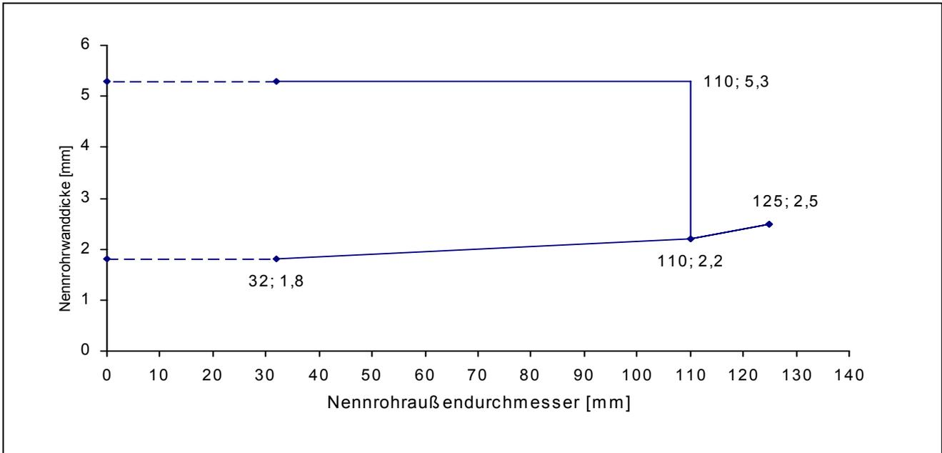
**Rohre gemäß Rohrgruppe A-2 (Einbau in Decken)**
