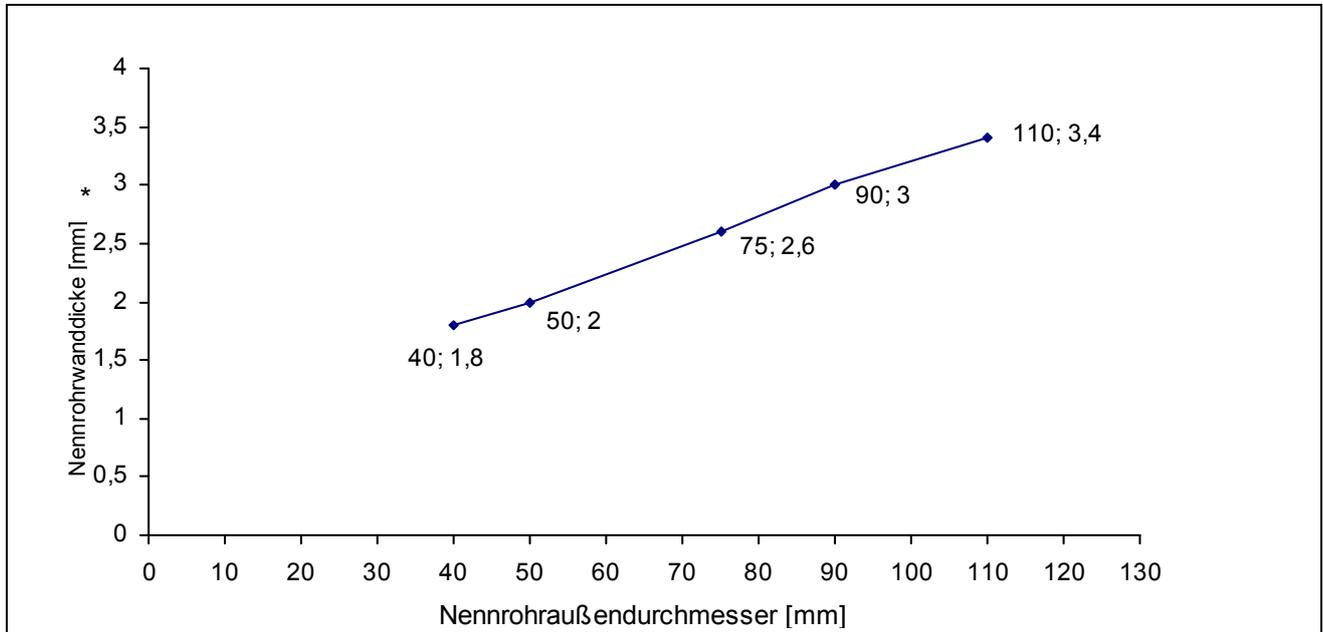
\* untere Rohrwandstärke  $s_{min}$  gemäß allgemeiner bauaufsichtlicher Zulassung Nr. Z-42.1-241
