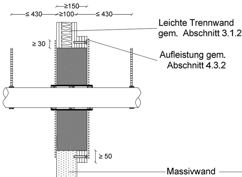
**Einbau in Wände  $d \geq 150$  mm**
