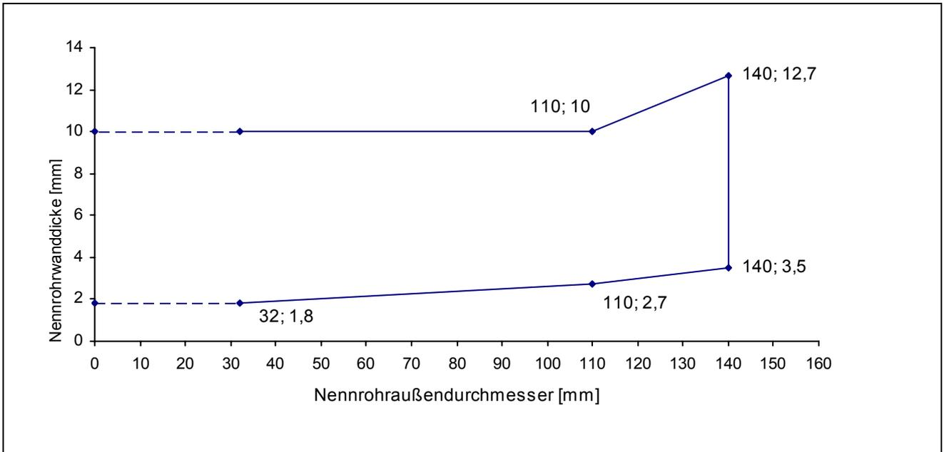
**Rohre gemäß Rohrgruppe B-2 (Einbau in Decken)**
