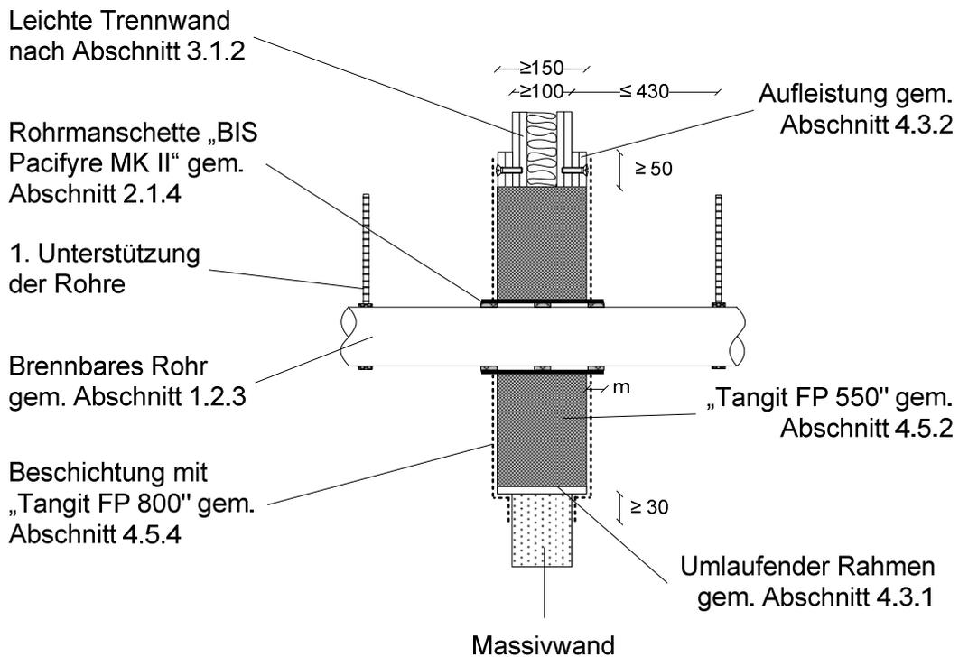
**Einbau in Wände  $d \geq 100$  mm
