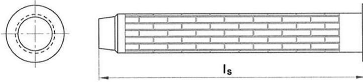
**Ankerstangen VMU-A, V-A oder handelsübliche Gewindestangen M8, M10**
