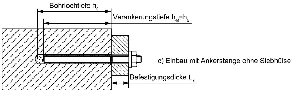
Dübel in eingebautem Zustand im Porenbeton
