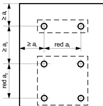
Reduzierte zulässige Lasten bei reduzierten Achsabständen je Dübel bei Dübelgruppen  $\min a \leq \text{red } a \leq a$  (siehe Abschnitt 3.2.3.1)
