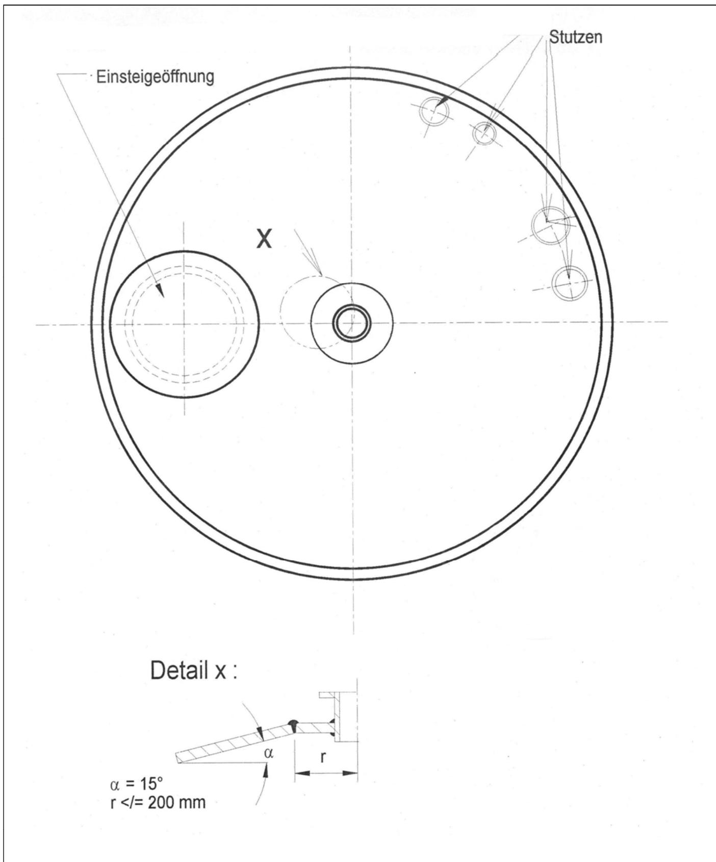
Flachbodenbehälter und Auffangvorrichtungen
