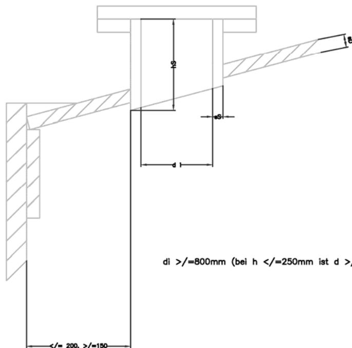
$d_i \geq 800\text{mm}$  (bei  $h \leq 250\text{mm}$  ist  $d \geq 600\text{mm}$  möglich)
