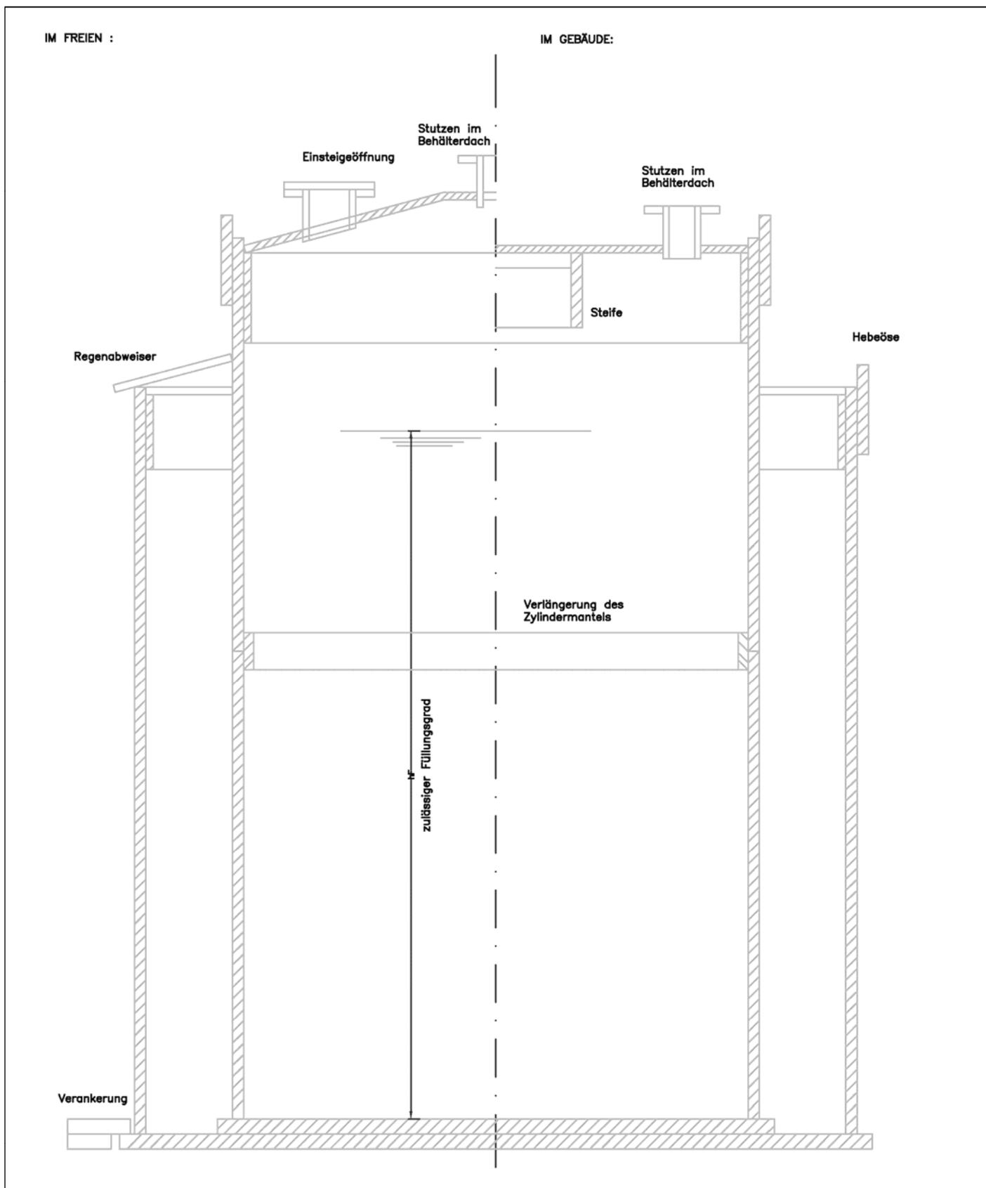
Flachbodenbehälter und Auffangvorrichtungen
