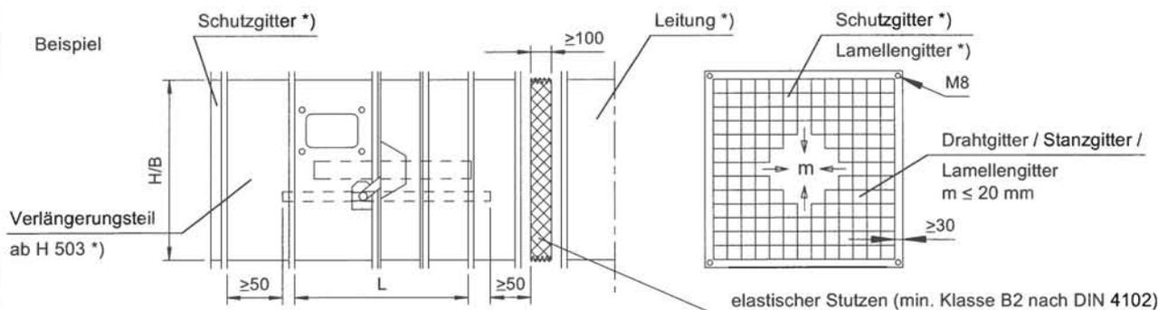
\*) aus nichtbrennbaren Baustoffen (Klasse A nach DIN 4102), wenn Abstand vom Klappengehäuse  $< 1,5 \times H$  (bzw. B)
