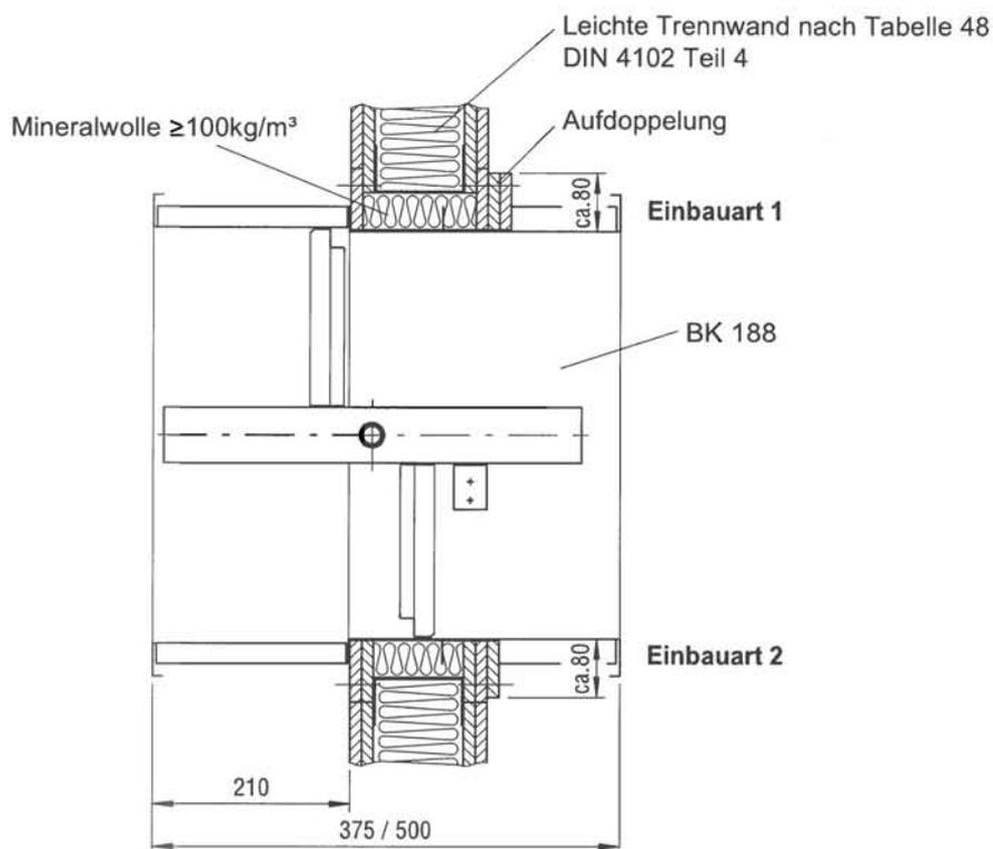
Anschluß an Lüftungsleitungen ist nur über flexible Stützen zulässig
