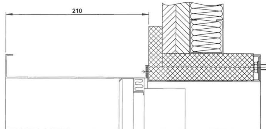
Anschluß an Lüftungsleitungen ist nur über flexible Stützen zulässig
