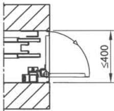
**Abdeckklappe** bei allen Torvarianaten als Seitenklappe (n) - und / oder Sturzklappe
