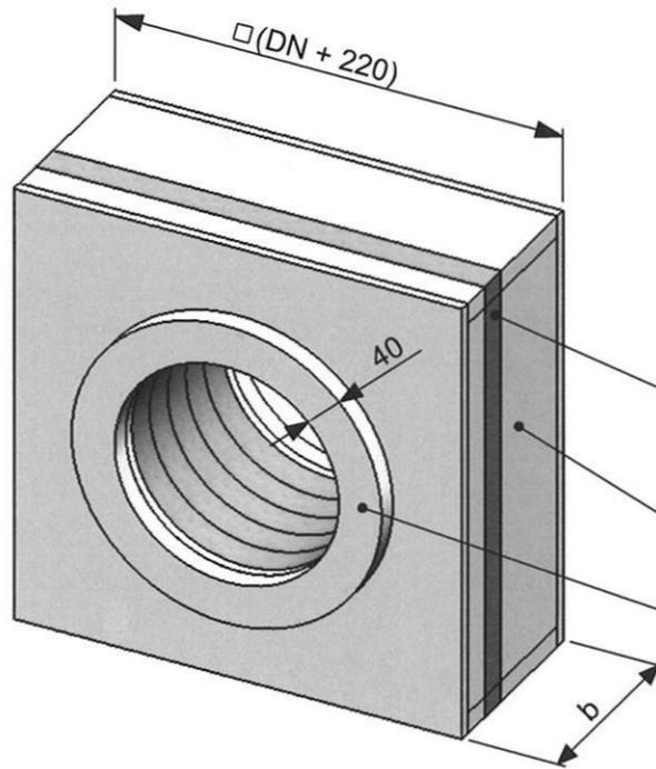
Teleskop-Spalt mit Mineralwolle (>1000°C) verfüllt
