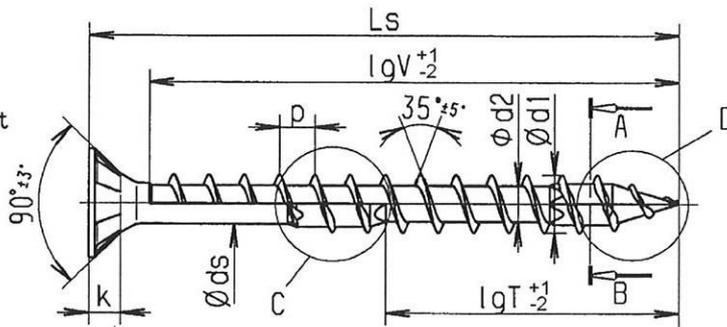
C: alternativ mit 4CUT-Fräser möglich
