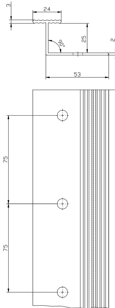
**Vertikales Verbindungsprofil "PVC Verbindungsleiste" (Maße in mm)**
