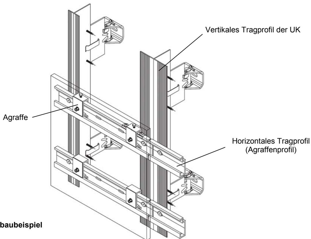
Keil Hinterschnittanker KH in Verbindung mit Fassadenplatte "Petaluxe Fassade"
