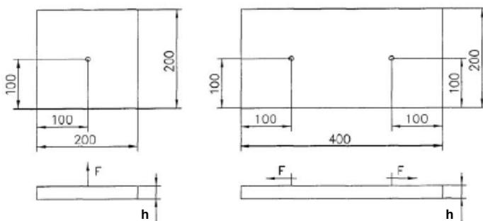
Bild 1: Versuchskörper zentrischer Zug und Querzug
