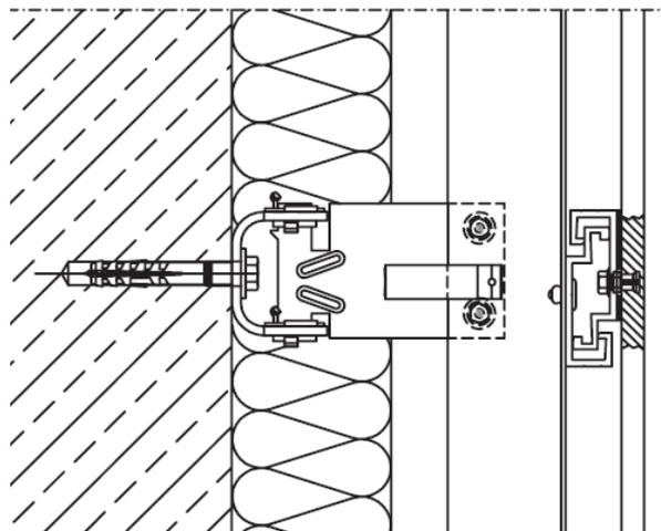
Keil Hinterschnittanker KH in Verbindung mit Fassadenplatte "Petaluxe Fassade"
