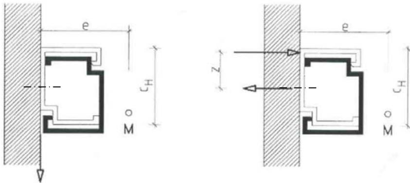
Bild 2: Torsion horizontaler Tragprofile aus Eigengewicht der Fassadenplatte
