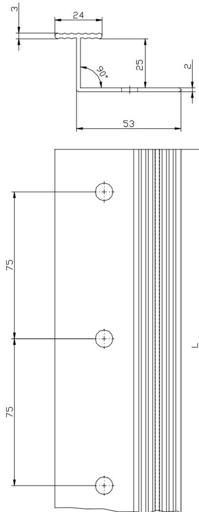
**Vertikales Verbindungsprofil "PVC Verbindungsleiste" (Maße in Millimetern)**
