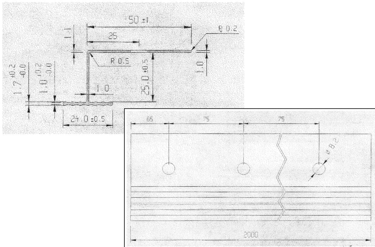
**Vertikales Verbindungsprofil – "Alu-Verbindungsleiste" (Maße in mm)**
