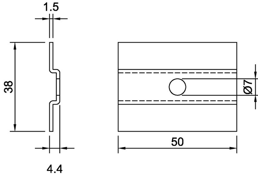
Die Edelstahl-Einlegeplatte darf nur in Verbindung mit dem Andruckprofil 927551 (siehe Anlage 4) verwendet werden.
