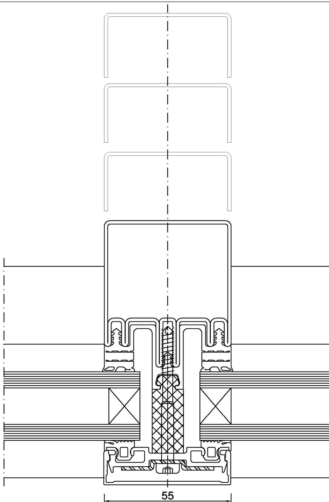
Klemmverbindung für das Fassadensystem *FERRO-WICTEC 55*
