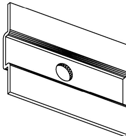
Klemmverbindung für das Fassadensystem *FERRO-WICTEC 55*
