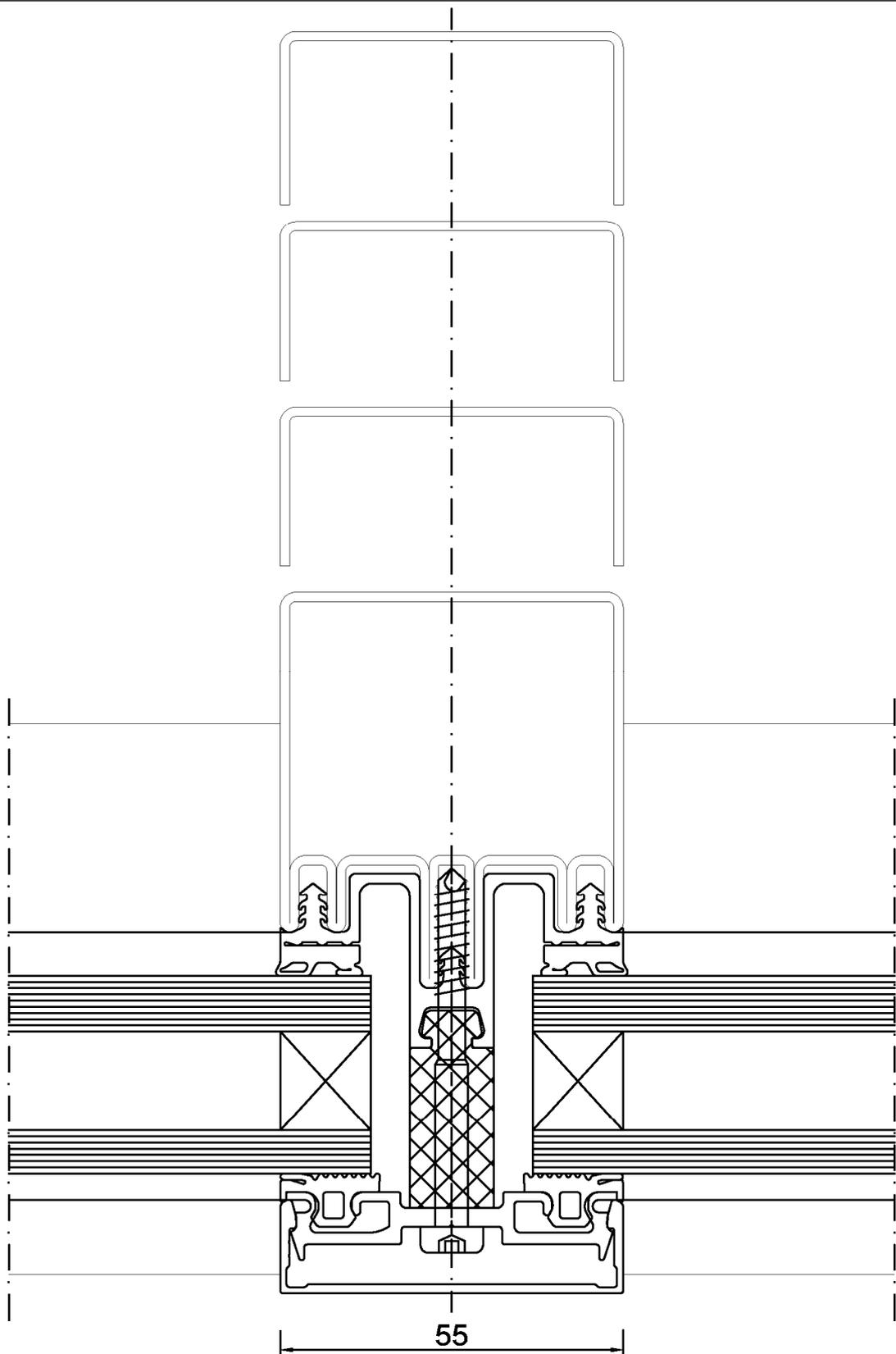
Klemmverbindung für das Fassadensystem *FERRO-WICTEC 55*
