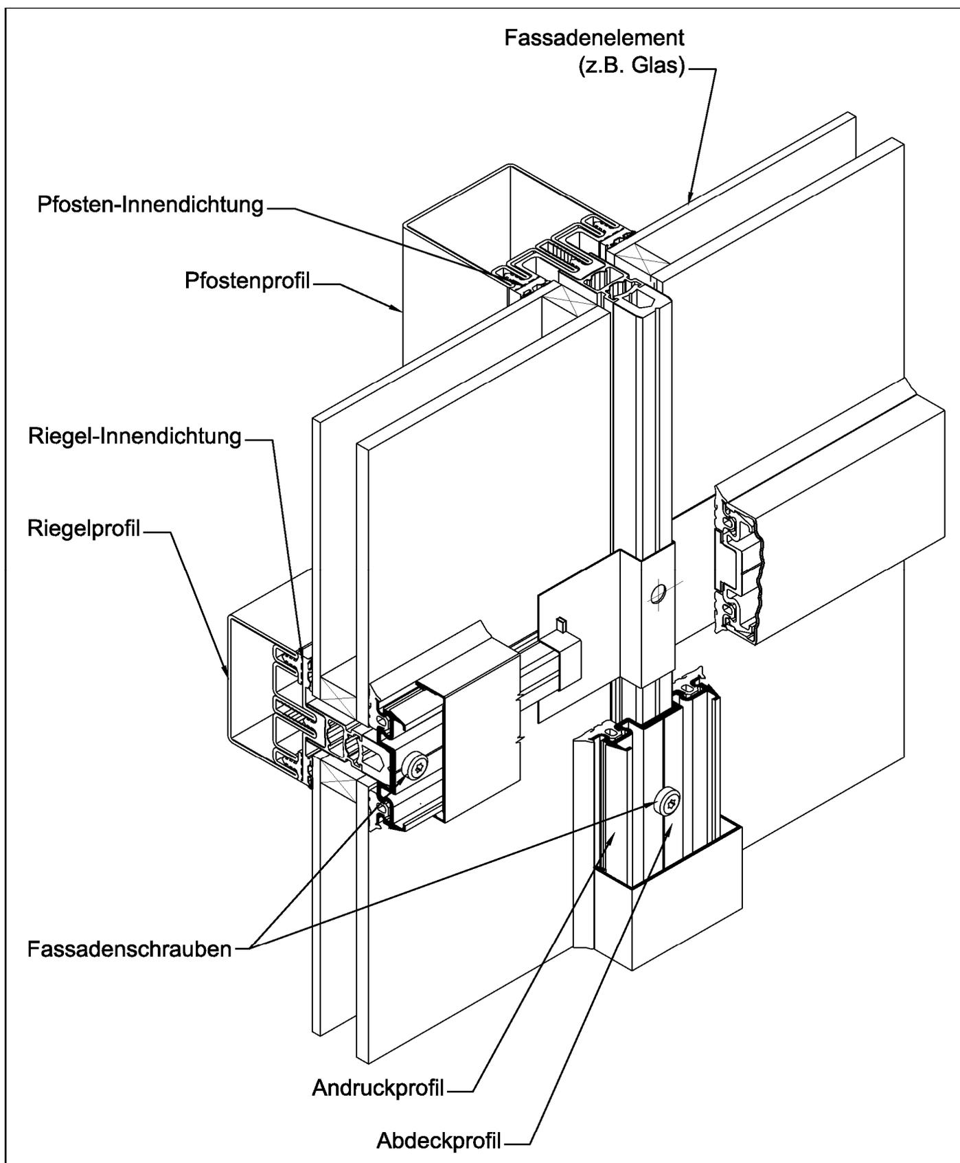
Klemmverbindung für das Fassadensystem *FERRO-WICTEC 55*
