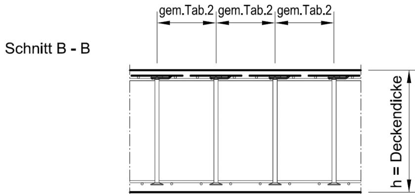
HALFEN Doppelkopfanke Typ HDB-G-S als Querkraftbewehrung nach DIN EN 1992-1-1
