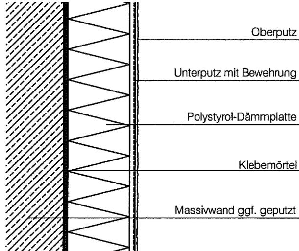
Mit Dübeln mechanisch befestigtes WDVS und zusätzlichem Klebemörtel
