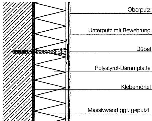
Mit Profilen mechanisch befestigtes WDVS und zusätzlichem Klebemörtel
