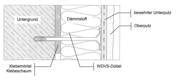
Wärmedämm-Verbundsystem "Brillux WDVS EPS Armierungsmasse ZF" nach ETA-07/0089
