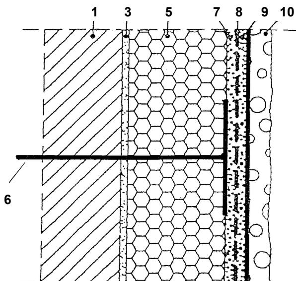
**Mit Dübeln mechanisch befestigtes WDVS und zusätzlichem Klebemörtel**
