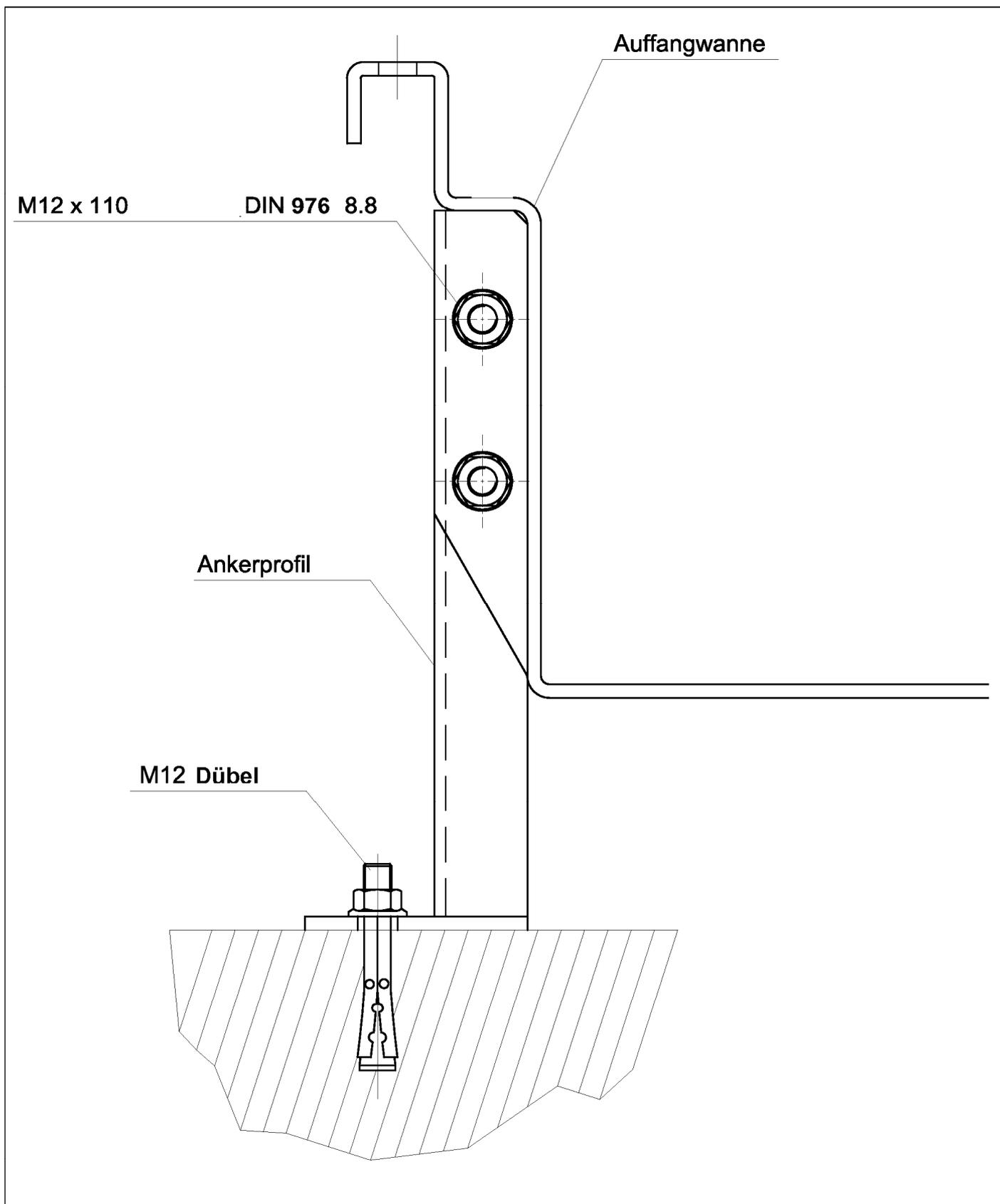
Auffangwanne aus Stahl als Unterbau von Gefahrstoffcontainern vom Typ AYC
