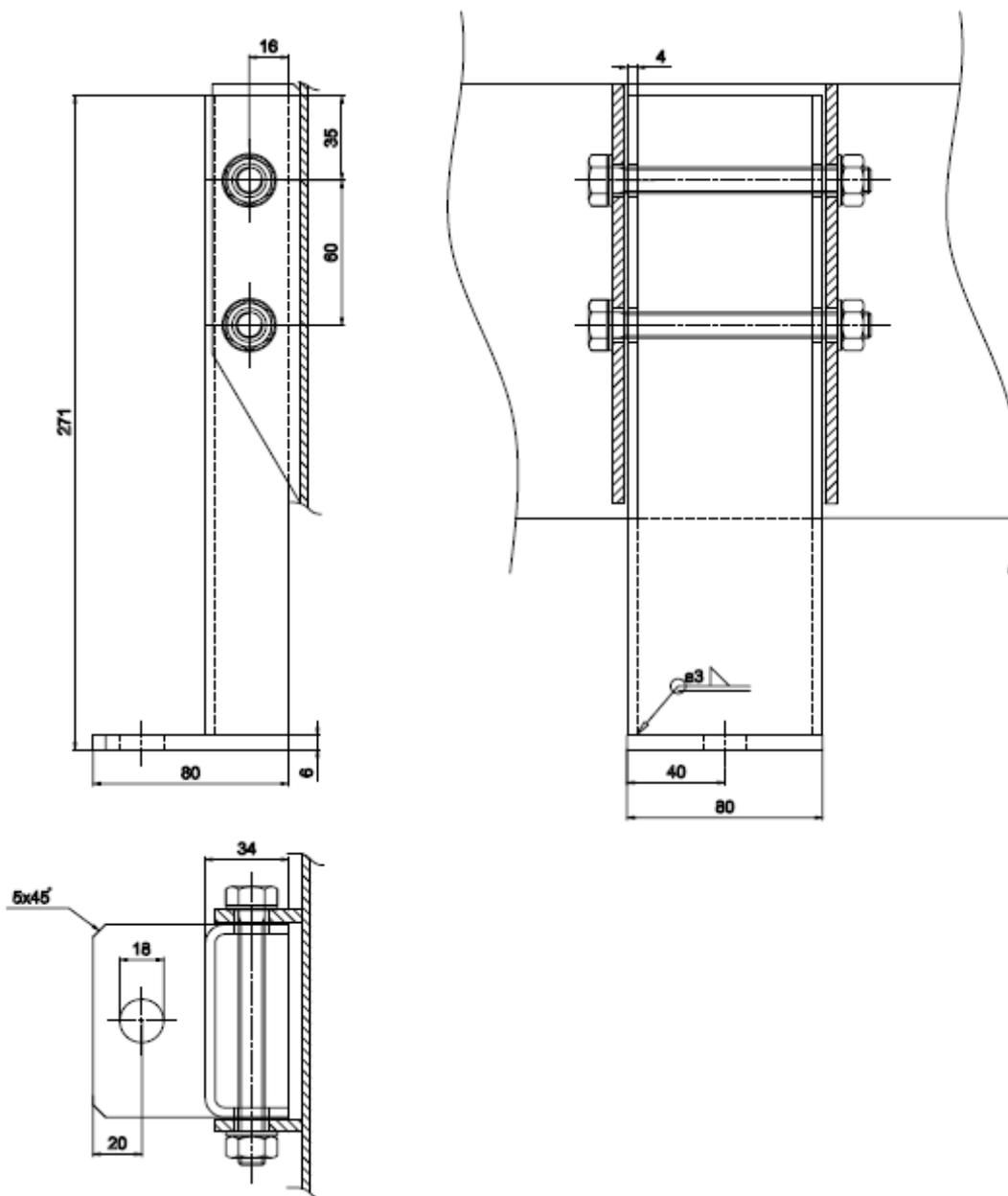
Auffangwanne aus Stahl als Unterbau von Gefahrstoffcontainern vom Typ AYC
