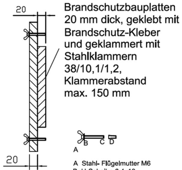
Brandschutzbauplatten 20 mm dick, geklebt mit Brandschutz-Kleber und geklammert mit Stahlklammern 38/10, 1/1, 2, Klammerabstand max. 150 mm
