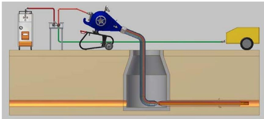
5. Aushärtung mit Kalibrierschlauch, heißes Medium wird zum Schlauchlinerkopf geführt und strömt im Schlauchliner zurück. Alternative: Mit Dampfauslassventil strömt das Dampf / Luft-Gemisch in Inversionsrichtung und tritt am Schlauchlinerkopf aus.
