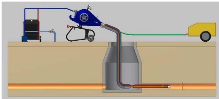
2. Schlauchliner mit epros®LinerEndCap invertieren
