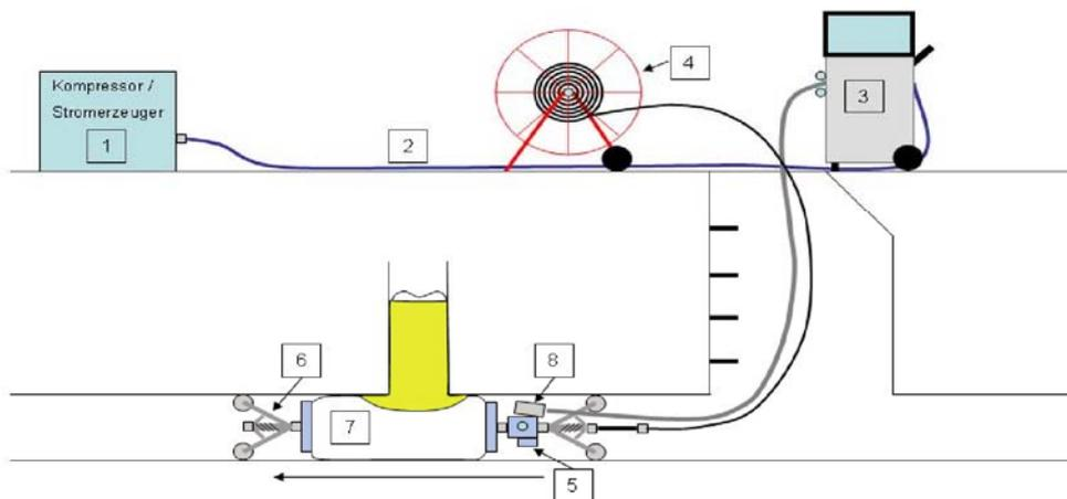
1. Kompressor min. 300 l/min / 8bar
