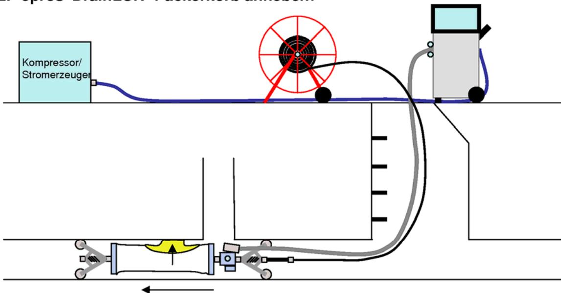
Das Vakuum im Packer brechen, indem der an der epros® DrainLCR-Steuerbox befindliche Hebel „Air / Vakuum“ kurzzeitig auf „Air“ (gegen Uhrzeigersinn) gedreht wird. Jetzt kann der epros® DrainLCR-Packerkorb angehoben werden. Den Hebel „Pathfinder“ (gegen den Uhrzeigersinn) auf „up“ drehen. Der epros® DrainLCR-Packerkorb hebt sich nun gegen die Rohrwandung.
