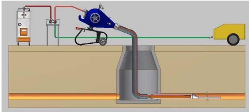
4. Kalibrierschlauch in den Schlauchliner inversieren. Für Zirkulation den Heizschlauch mit inversieren, andernfalls das Dampfauslassventil an den Kalibrierschlauchkopf einbinden.
