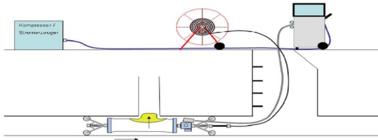
epros® DrainLCR-Packer zurückziehen, bis sich der epros® DrainLCR-Packerkorb in den Stützen hinein schiebt und dadurch einrastet.
