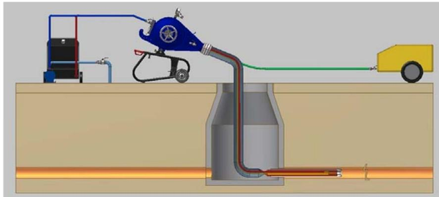
2. Schlauchlinier mit Kalibrierschlauch gleichzeitig invertieren
