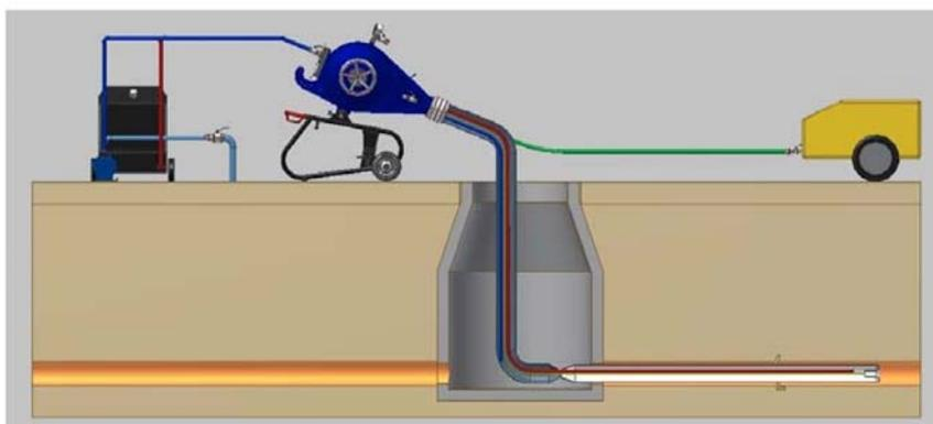
3. Warmmaushärtung, Medium wird zum Schlauchlinerende geführt und strömt im Schlauchliner zurück. Alternativ: Mit Dampfauslassventil strömt das Dampf / Luft-Gemisch in Inversionsrichtung und tritt am Schlauchlinerkopf aus.
