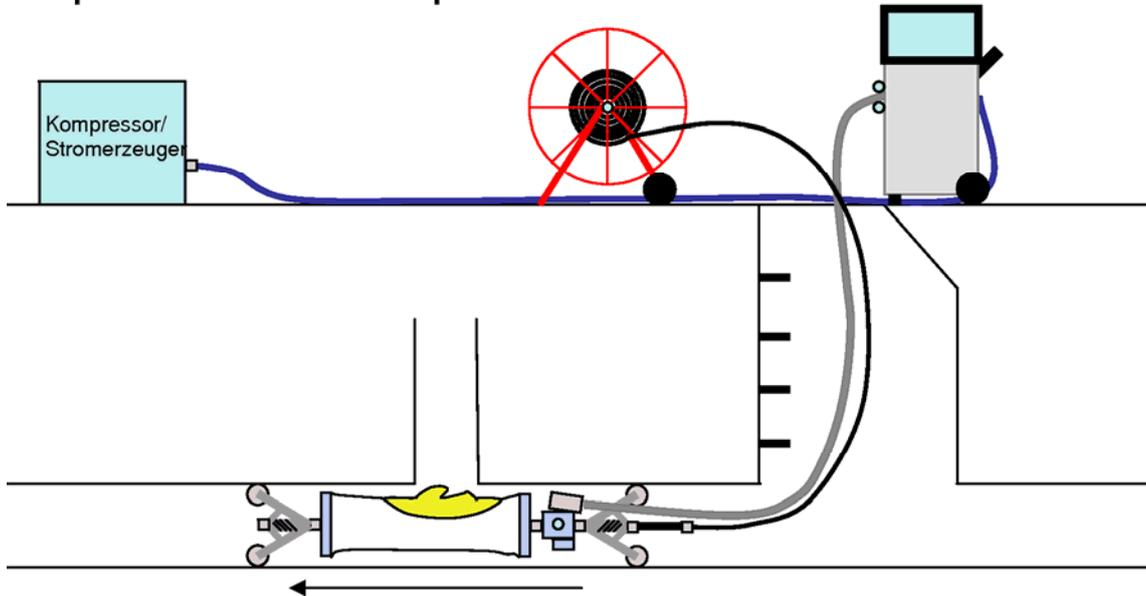
epros® DrainLCR-Packer hinter den Stützen schieben. Mit Hilfe der Kamera den epros® DrainLCR-Hebekorb fluchtend zum Stützen drehen.
