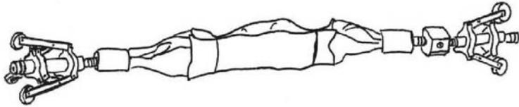
B. Leicht angeblasener Packer nach der Positionierung
