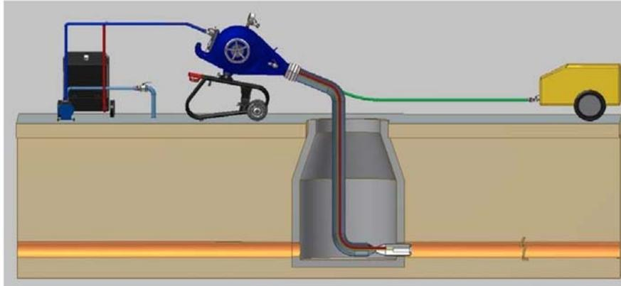
1. Schlauchliner am Startpunkt positionieren, Steuerband und Heizschlauch fixieren.
