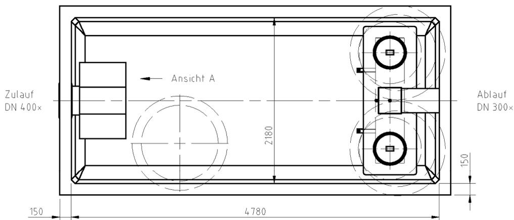
× Anschlüsse nach DIN 19534/19537 und DIN EN 877
