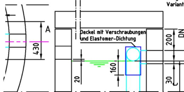
Abzug von Gesamtfölspeichermenge bei Verwendung der integrierten Probenahmestelle Variante1
