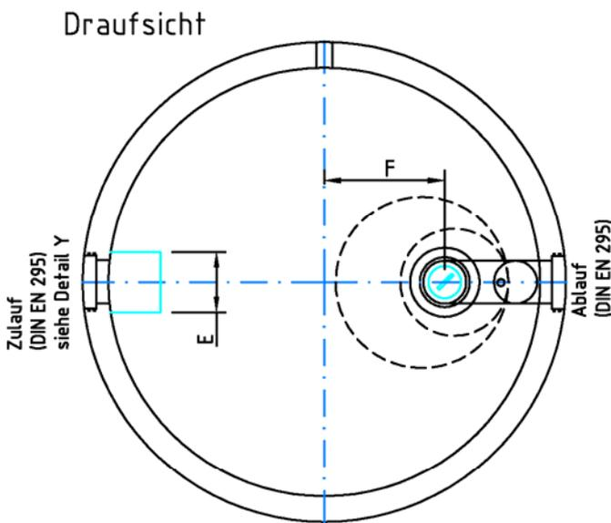
Standarddeckenöffnungen (U) im Behälter Ø A 2000: 1 x Ø 1000 oder 2 x Ø 800, alternativ bei geringen Zulaufhöhen: 1 x Ø 625 oder 2 x Ø 625
