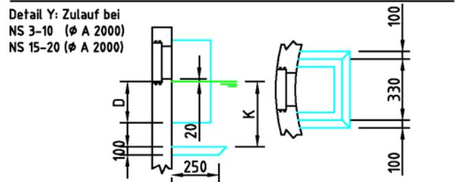
Abscheideranlage aus Beton mit einem Abscheider Klasse I mit Koaleszenzeinrichtung, einem integrierten Schlammfang und einer integrierten bzw. separaten Probenahmestelle
