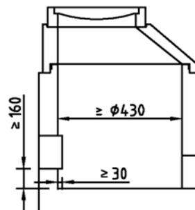
Abscheideranlage aus Beton mit einem Abscheider Klasse I mit Koaleszenzeinrichtung, einem integrierten Schlammfang und einer integrierten bzw. separaten Probenahmestelle
