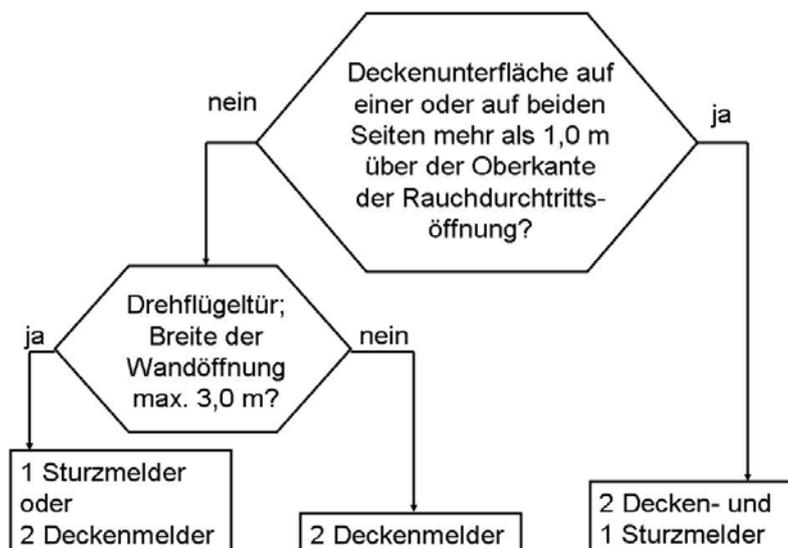
Bild 3: Entscheidungsdiagramm
