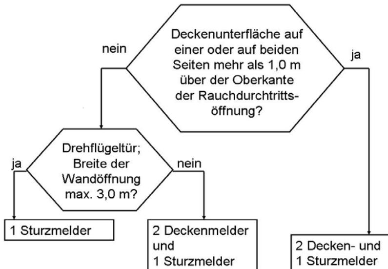
Bild 3: Entscheidungsdiagramm
