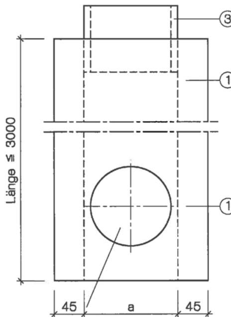
Ausschnitt zur Einführung des Verbindungsstückes (Leitung zwischen Feuerstätte und Abgasleitung)
