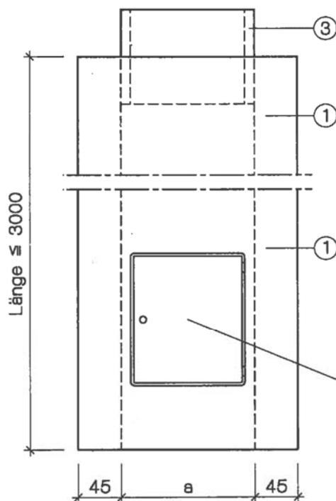
Reinigungsöffnung mit entsprechendem Verwendbarkeitsnachweis, Anordnung nach den Bestimmungen der zugelassenen Abgasleitung
