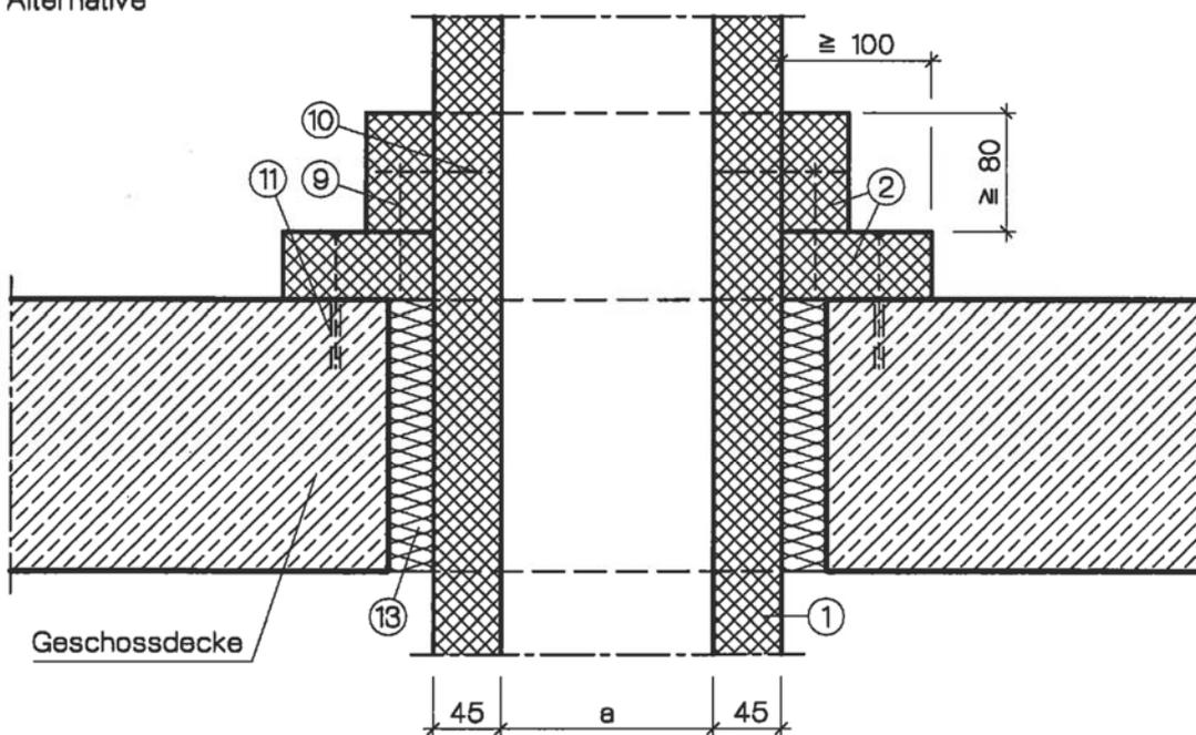
Schachtelemente "FUMO-LUX" zur Herstellung von Montageabgasanlagen T400 L90
