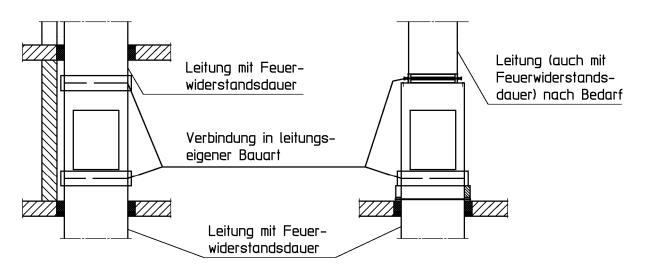
Deckendurchbruch und Lastabhängung nach dem allgemeinen bauaufsichtlichem Prüfzeugnis der Entrauchungsleitungen.
