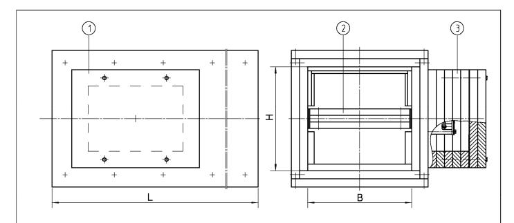
Abmessungen: B = 201 bis 1500 mm
