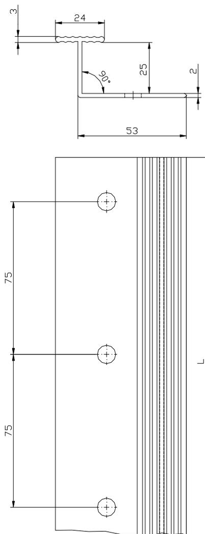
**Vertikales Verbindungsprofil "ZEROTHERM PVC Verbindungsleiste" (Maße in mm)**
