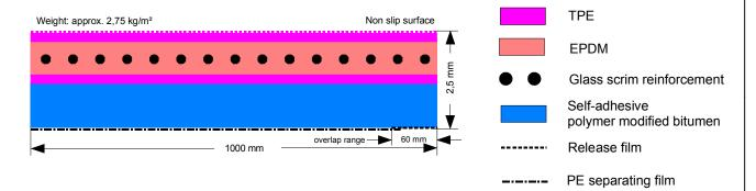
Bitumen – verträgliche, Heißluft verschweißbare EPDM-Synthesekautschukabdichtungsbahn \*) W Markierung für Wurzelfestigkeit
