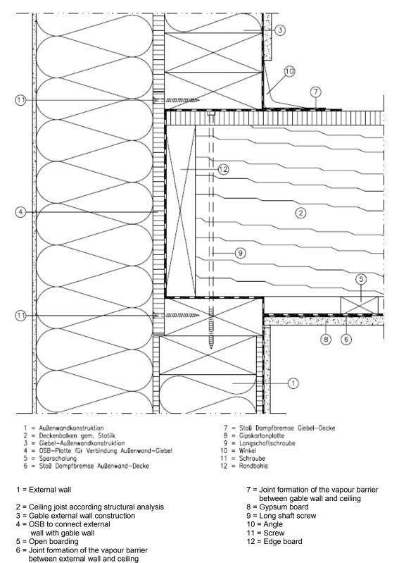
Die tragenden Anschlüsse sind nur prinzipiell dargestellt. Sie sind gemäß den technischen Regeln zu bemessen und gemäß der statischen Berechnung auszuführen.
