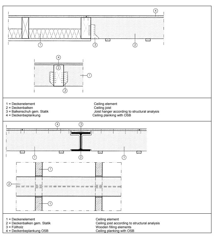
Die tragenden Anschlüsse sind nur prinzipiell dargestellt. Sie sind gemäß den technischen Regeln zu bemessen und gemäß der statischen Berechnung auszuführen.
