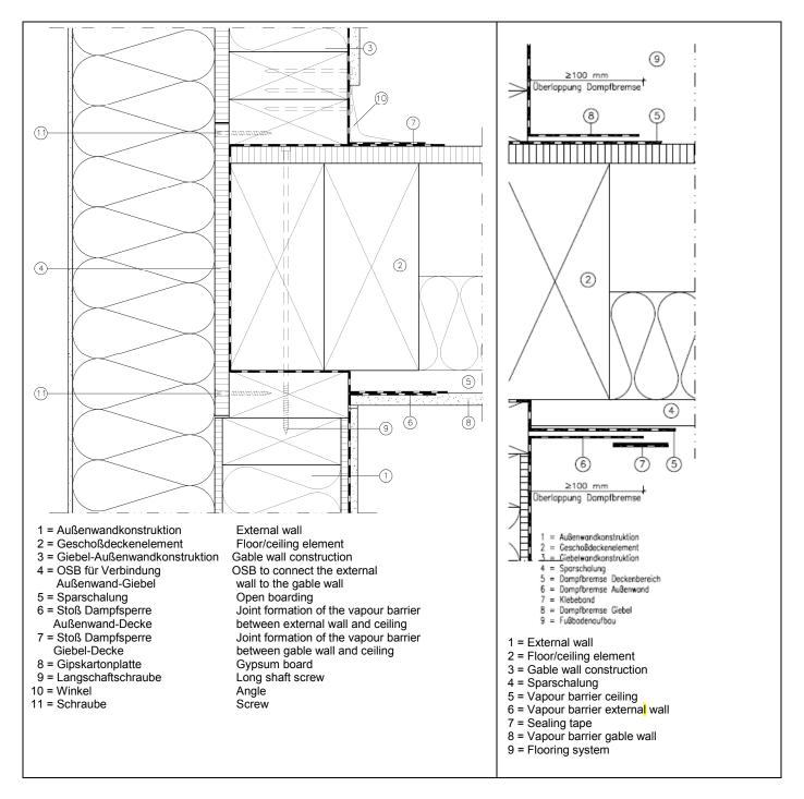
Die tragenden Anschlüsse sind nur prinzipiell dargestellt. Sie sind gemäß den technischen Regeln zu bemessen und gemäß der statischen Berechnung auszuführen.
