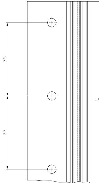
**Vertikales Verbindungsprofil – "HECK Verbindungsschiene PVC" (Maße in mm)**
