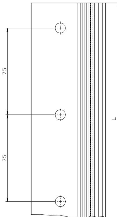
**Vertikales Verbindungsprofil "PVC Verbindungsleiste" (Maße in mm)**
