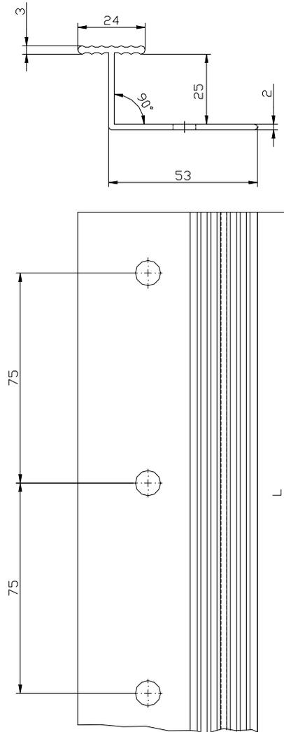
**Vertikales Verbindungsprofil " isoprotego Verbindungsschiene" (Abmessungen in Millimetern)**
