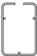
Bild 3: Bügelkorb für: \Delta\sigma_{Rsk} = 85 \text{ MPa} (bei N=1 \cdot 10^6 Lastzyklen)
